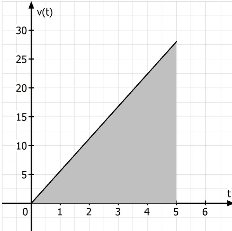
Überlegen Sie, welche Strecke das Auto in den ersten fünf Sekunden zurücklegt und kennzeichnen Sie im v-t-Diagramm, wo man die Strecke im v-t-Diagramm „sieht“.
